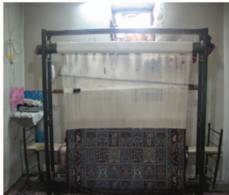
شکل ۳- دار قالیبافی-عمودی با پایه فلزی
