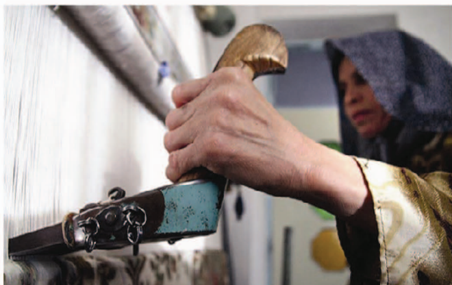
شکل ۱۱- عملیات شانه زنی هنگام بافت فرش
