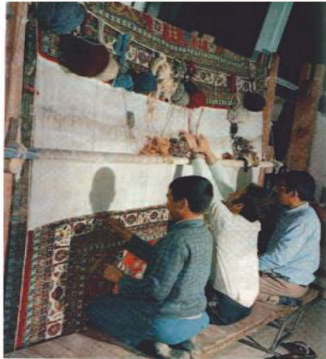
شکل ۵- دار عمودی با پایه های چوبی
